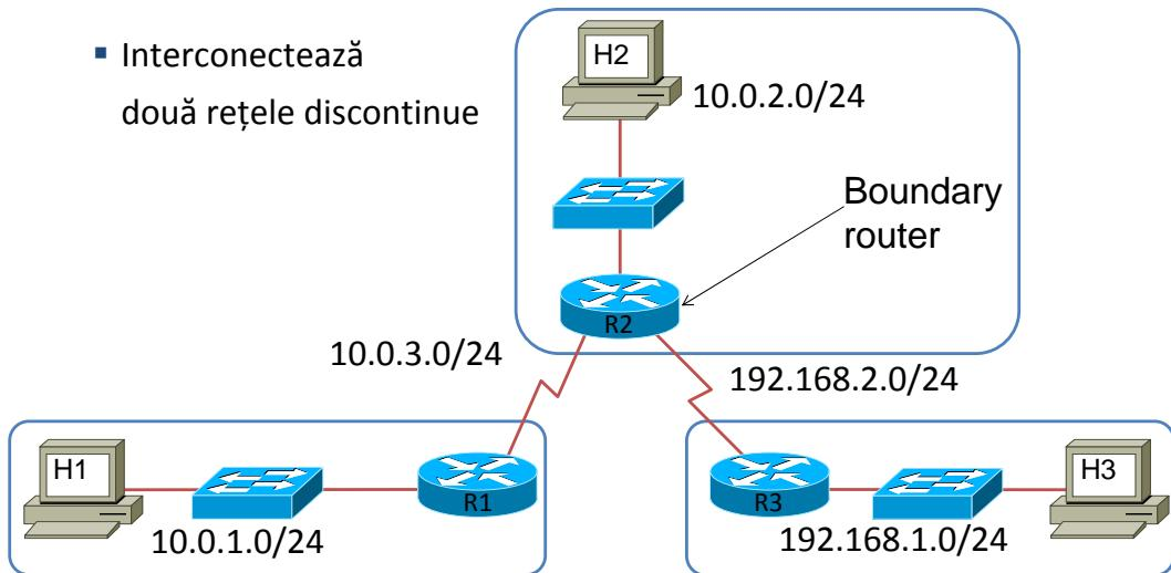
Fiind un protocol de rutare classful, RIPv1 va summariza automat rețelele conform adresării classful. În figură, se observă că R2 este conectat la mai multe rețele classful, din această cauză ruterul R2 este considerat un ruter de tip „boundary router”.
